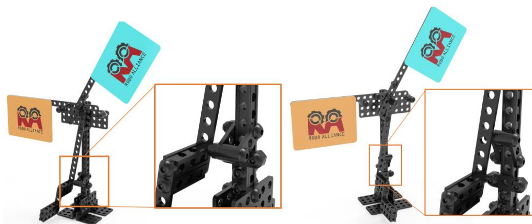
图 2.9 “固定旗台”完全激活状态（左）和“固定旗台”未完全激活状态（右）
